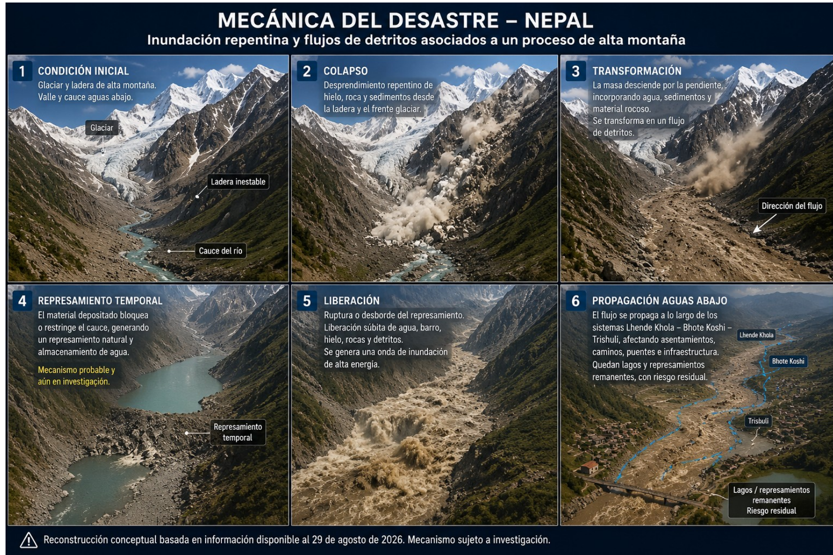
Figura 1. Mecánica del desastre – Nepal. Reconstrucción conceptual de la secuencia del fenómeno, desde las condiciones iniciales de alta montaña hasta la propagación de la inundación repentina y los flujos de detritos aguas abajo. La representación se basa en los antecedentes disponibles y podrá ser actualizada conforme avance la investigación científica del evento.
